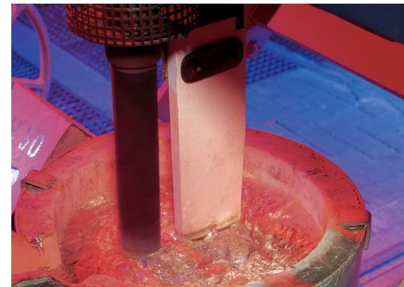
Das Rotordesign ist der Schlüssel für eine optimale Reinigung und Entgasung der Schmelze; Rotoren müssen dabei folgende Aufgaben erfüllen:
