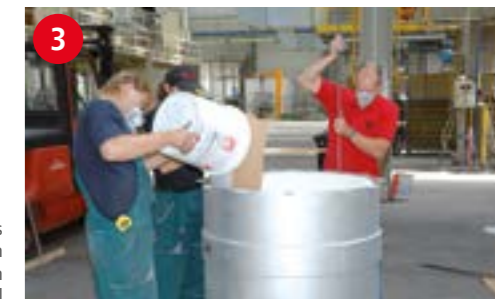
3 Einsetzen des ATL-Einsatzes in den vorbereiteten Stahlmantel
