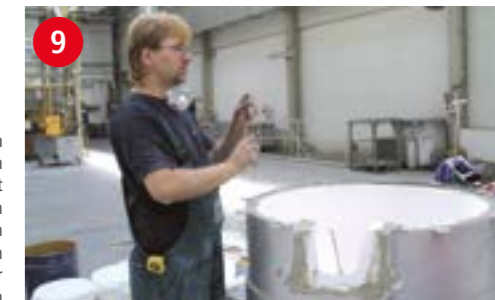
9 Vor dem Aufheizen von außen zum Start der exothermen Aushärtereaktion werden Entlüftungslöcher gestochen
