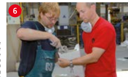
6 Die zugeschnittene Gießschnauze wird mit dem INSURAL 800 Kleber allseitig versehen
