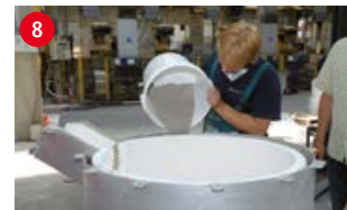
8 Die restliche Füllmasse wird bis knapp unter dem Rand aufgefüllt und verdichtet und anschließend mit einer ca. 15 mm Schicht INSURAL 800 versiegelt
