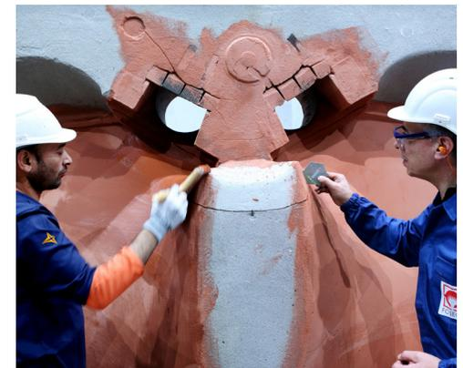
Auftrag der Schichte mit Hilfe eines Pinsels zur Verbesserung der Gussstückoberfläche
