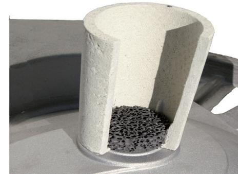
Bild 2: Sandgussteil (Gewicht 31,5 kg) gegossen mit einem KALPUR AL Einsatz. Steigerung des Ausbringens auf 75%
