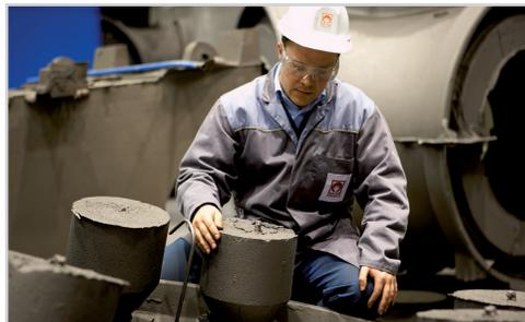
Pumpengehäuse mit Foseco Speisern
