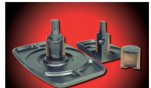
Pufferplatte mit Filterspeiser
