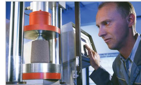
Die neu konzipierten Speiser und die charakteristische Kerntechnologie wurden entwickelt, um höchsten Verdichtungsgraden bei Formanlagen standzuhalten
