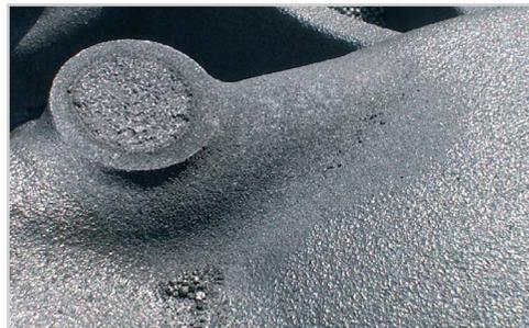
Das Ergebnis ist ein Speiser, bei dem das Putzen entfällt, bzw. auf ein Minimum reduziert wird
