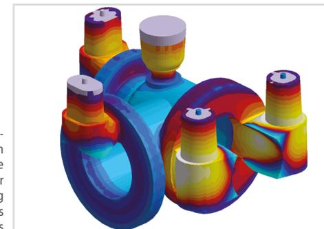
Exakte thermophysikalische Daten ermöglichen eine genaue Voraussage der Formfüllung, Erstarrung und Speisung des Gussstückes
