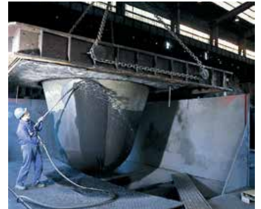
Çok süratli bir şekilde kalıp yüzeyinde tabaka oluşturur
