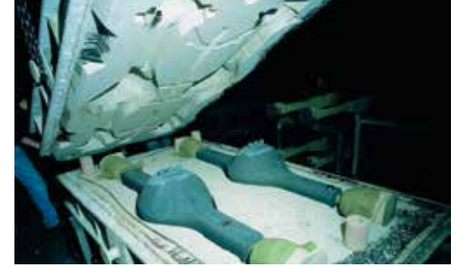
Sfero dökümde lamelleşmeyi engelleyen boya
