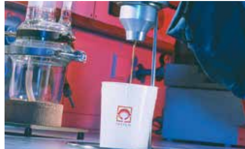
DIN kabı kullanarak viskozite ölçümü
