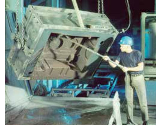
Yıkama boya tekniği kalıp yüzeyinde her bölgenin eşit kalınlıkta boyanmasına olanak verir
