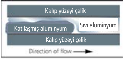
Şekil 3: Soğuk birleşme oluşumu
