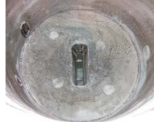
KELLUNDITE 857 ile astarlanmış kanallı ocak indüktörü
