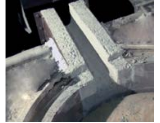
BLU-RAM HS plastik malzemesi uygulanmış gaganın görünümü
