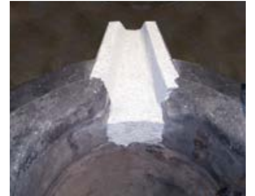
BLU-RAM HS plastik malzemesi uygulanmış gaganın görünümü
