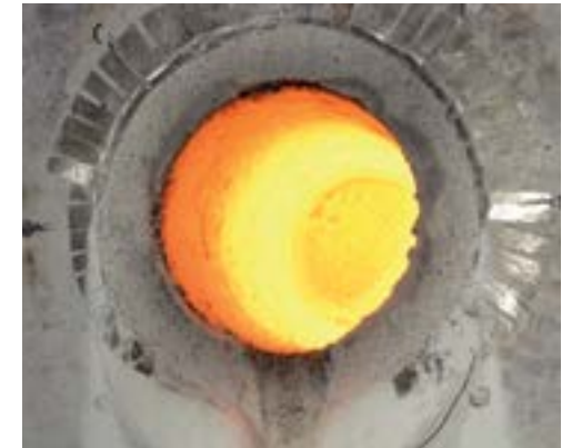
KELLUNDITE ile astarlanmış ocağın görünümü
