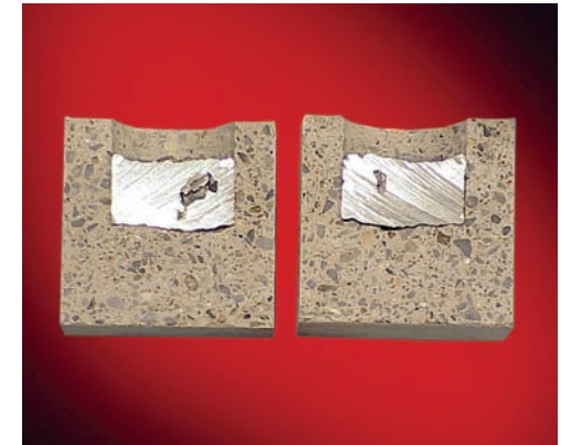
ALUGARD CE-S için kap testi
