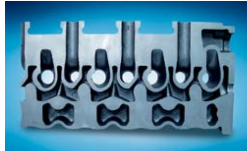
Şekil 1 Silindir kafası içinde karmaşık geçişler
