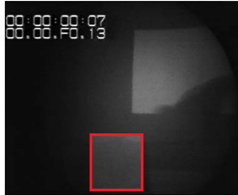
Seramik köpük filtreden geçerek kalıp boşluğunu dolduran metal akışı.
