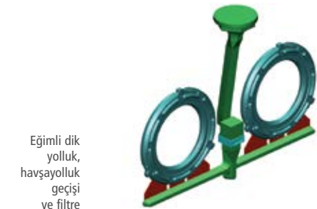
Türbülanslı kalıp dolumu, metalin kalıp duvarına direk çarpması
