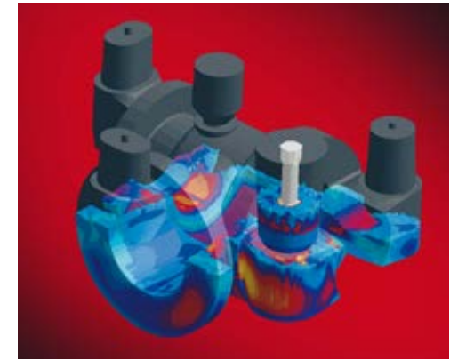
KALPUR ST direk döküm, yan besleyici
