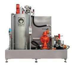
A Unidade inteligente de tinta automatizada da Foseco: controla a densidade da tinta em tempo real e, portanto, proporciona uma maior consistência na espessura da camada úmida
