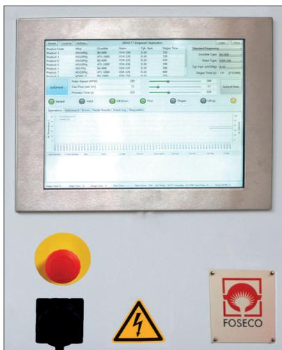
Figure 3 : Écran tactile intégré à la porte de l'armoire de contrôle du FDU
