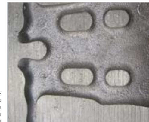
Durch eine erfolgreiche Weiterentwicklung des SOLOSIL TX-Additivs konnten die Metall-Sand-Reaktionen vollständig eliminiert werden
