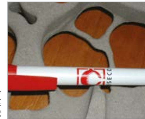
Vollständig verdichtete Kernstege dank SOLOSIL TX am Beispiel eines Wassermantelkerns für einen PKW-Aluminium-Zylinderkopf
