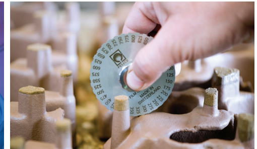
Nass-Schichtdickenmessung mittels eines Messkamms
