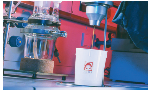
Viskositätsmessung mit einem Durchlaufbecher
