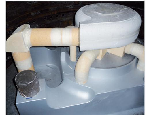
Modelleinrichtung mit vormontiertem keramischen Gießsystem
