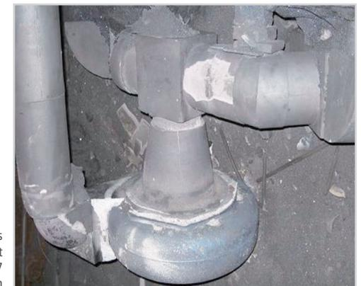
Gegossenes Laufsystem mit HOLLOTEX CFU 7 Filterhaltern
