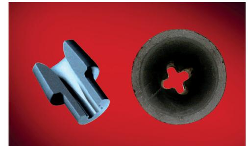
Metallfluss durch den Kreuzschlitzausguss
