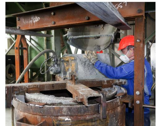
Einfüllen des Auskleidungsmaterials
